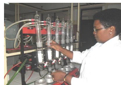
Extraction de matière grasse 6 postes, marque BEHR
